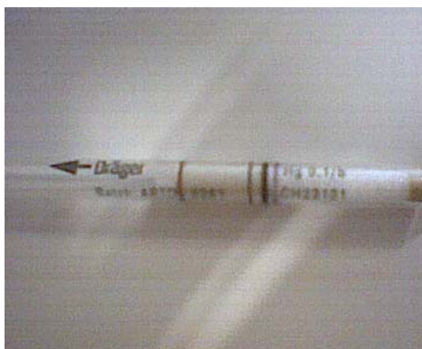
Figura 3: O tubo reagente/ Dräger Röhrchen
