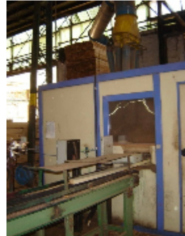
Figura 44 - Moldura entrando na cabine de pintura
