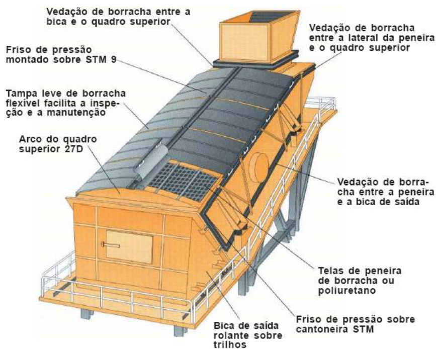
Figura 56 Esquema de Vedação dos Componentes da Instalação (2) Fonte: METSO (2005)
