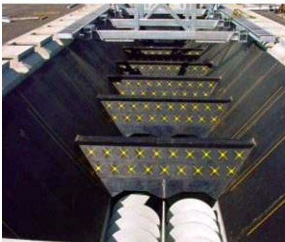
Figura 58 Foto Revestimento em Alimentador Fonte: METSO (2005)
