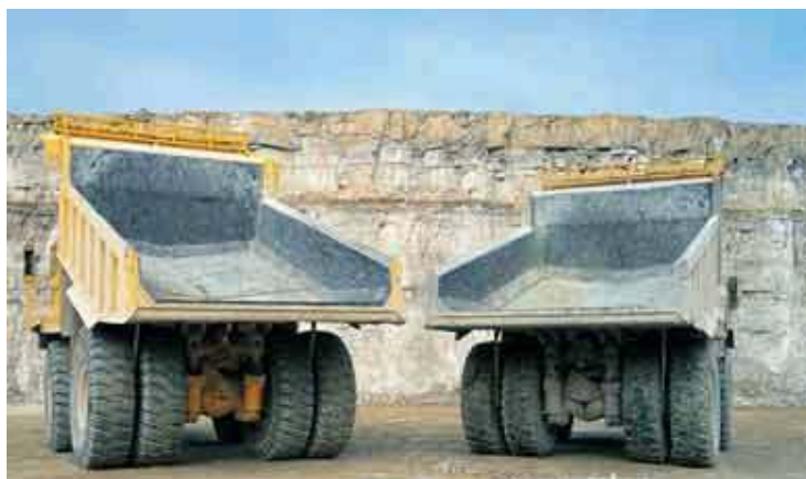
Figura 59 Foto Revestimento em Caçamba Fonte: METSO (2005)
