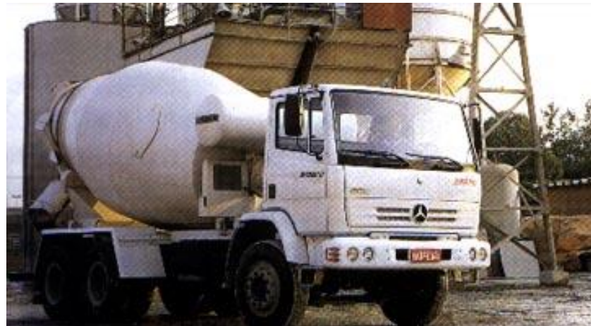
Caminhão-betoneira (concreto) – veículo rígido de 3 eixos
