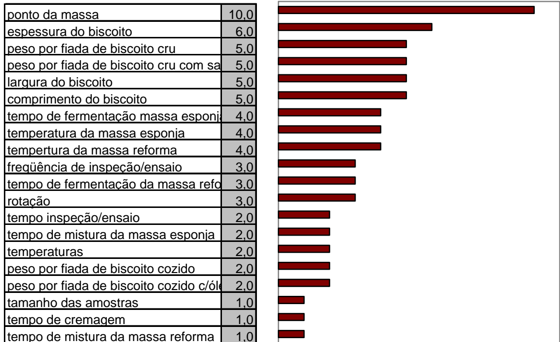
Figura 12: Priorização dos Parâmetros do Processos para o estudo de caso do biscoito.
